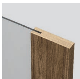
łączenie z szybą „na kant” skrzydło bezprzylgowe
