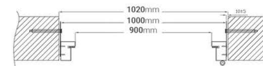
PRZYBLIŻONY WYMIAR OTWORU MONTAŻOWEGO
